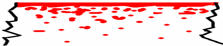
Fig. 5 – Diffusion du métal avec migration en surface.
